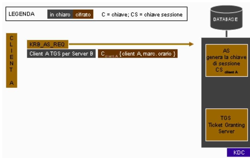
Il sistema client invia un messaggio composto da due componenti, una in chiaro e l'altra cifrata. Nella prima è contenuta una richiesta per ottenere il TGS che permetta l'accesso al Server B, nella seconda i dati necessari al AS, e quindi al KDC, per verificare l'identità del client: nome del sistema client e marcatore orario, il tutto cifrato con la chiave segreta del client.
