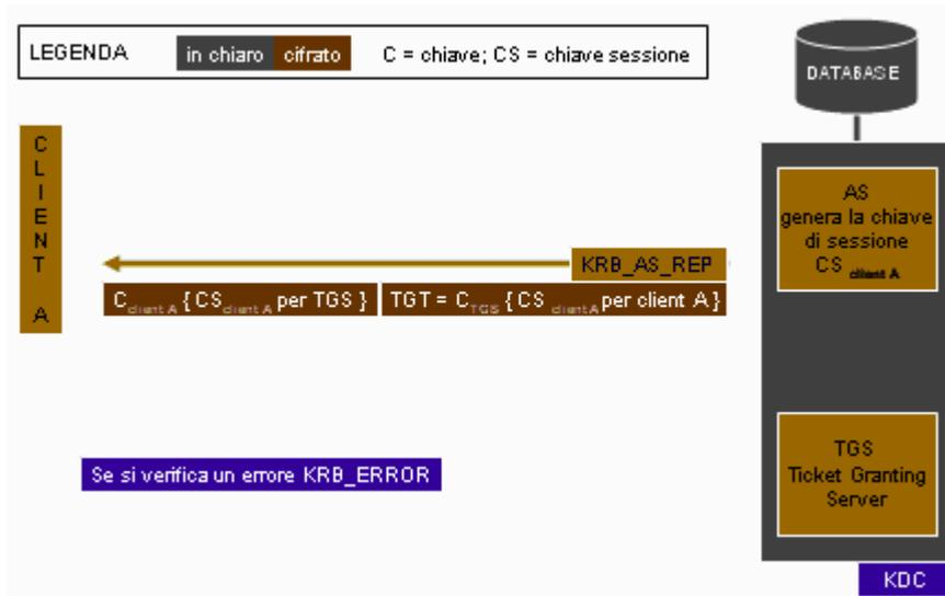
Una volta verificata l'identità del client, l'AS invierà un messaggio di risposta composto, anche in questo caso, da due componenti. La prima, cifrata con la chiave segreta del client, conterrà la chiave di sessione (CS) necessaria al client per comunicare con il TGS mentre la seconda, a parità del contenuto, sarà cifrata con la chiave segreta del TGS e quindi accessibile solo a quest'ultimo.
